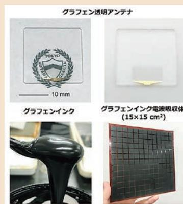
本研究所で作製した透明なグラフェンモノポールアンテナとグラフェンインク印刷により作製した電波吸収体
