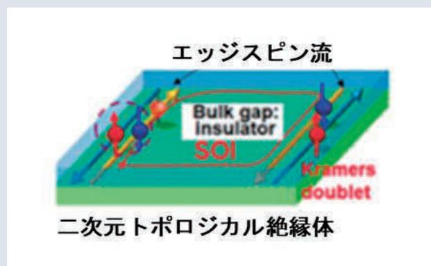
二次元トポロジカル絶縁体外観図：エッジを流れる電子スピンは散乱の影響を全く受けない
