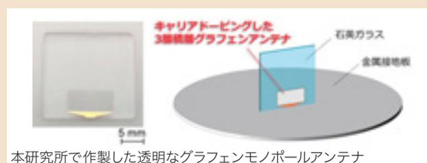
本研究所で作製した透明なグラフェンモノポールアンテナ
