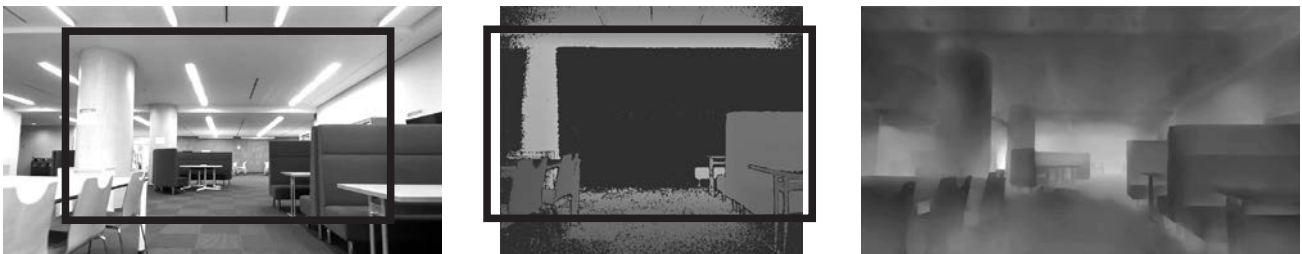
図1 センサで取得した画像（左）、深度画像（中央）及び提案モデルで補完した深度画像（右）。
