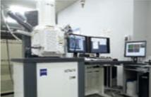
低加速高分解能走査電子顕微鏡(低加速FE-SEM)
